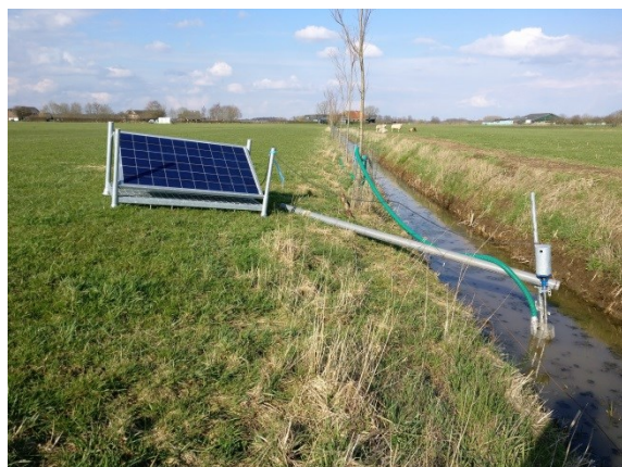
Plasdraspomp met zonnepaneel
